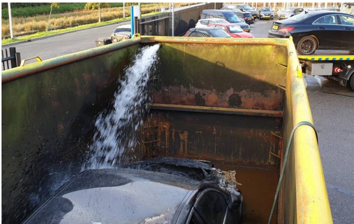
Figuur: dompelcontainer voor koelen elektrische auto
